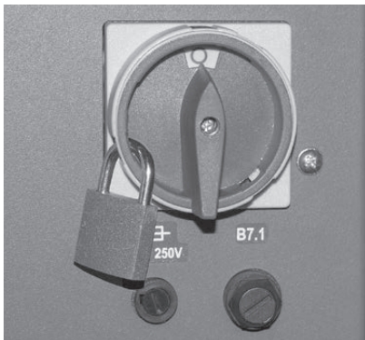
Fig. 3 Hauptschalter in „0“-Stellung bringen und mit einem Vorhängeschloss gegen Wiedereinschalten sichern
