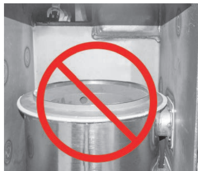
Fig. 66 Brennkammer NICHT reinigen oder auseinanderbauen – Beschädigungsgefahr!
