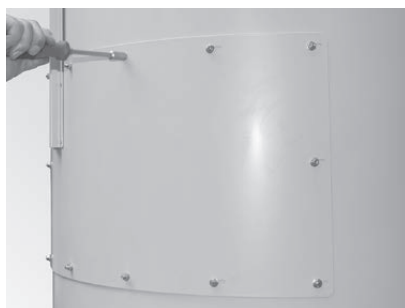
Fig. 78 Deckel bei Vorratsbehälter lösen
