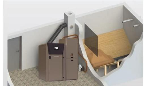
Raumaustragung mit Saugschnecken-Austragung
